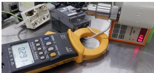
攪拌モーター、デコーダーで負荷を掛け停電稼働
