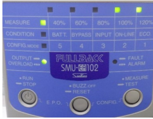
バッテリー電圧測定
